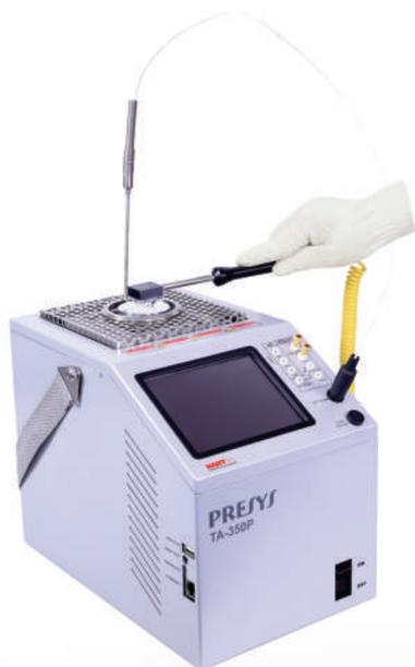
Un insert avec une sonde de référence permettant le contrôle et la mesure de la température en dessous de la surface a été développé afin de pouvoir étalonner vos sondes de surface.
