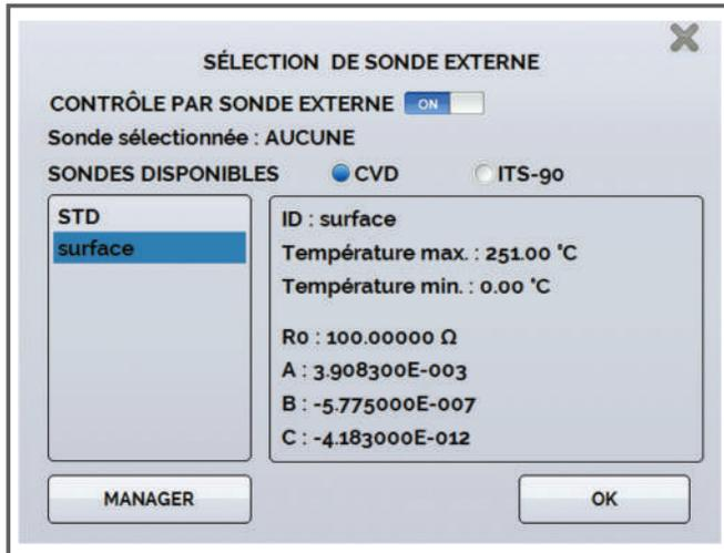
Les fours TA disposent d'une voie de mesure pour une sonde de référence externe, qui peut-être utilisée pour améliorer l'exactitude, éliminer le décalage et l'effet de charge, spécialement lorsque vous travaillez avec les inserts bain liquide ou les inserts sanitaires qui présentent des masses thermiques différentes.
