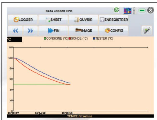
Les fours TA disposent d'un système d'enregistrement de données permettant la visualisation graphique ou sous la forme de tableau.
